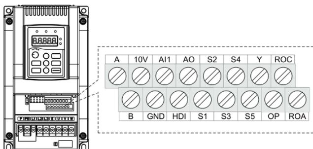
Рисунок 3-6. Схема расположения клемм цепей
