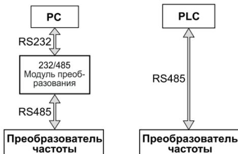
Рисунок 7-1. Режим «Одно ведущее устройство и одно ведомое устройство»
