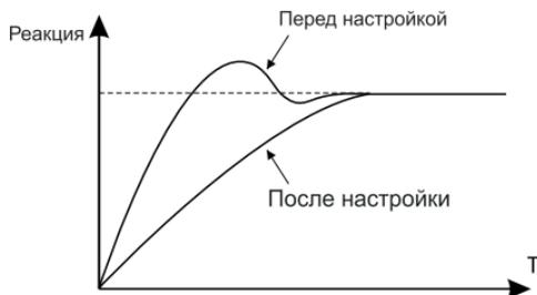
Контроль вибрации низкой частоты: если периоды вибрации имеют большую продолжительность по сравнению с установленным временем интегрирования ( $T_i$ ), необходимо увеличить время интегрирования ( $T_i$ ), чтобы компенсировать вибрацию.
