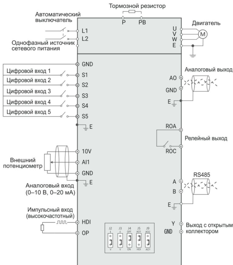
Рисунок 3-4. Схема основных электрических соединений (2)
