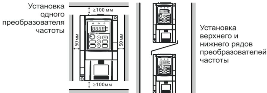
Рисунок 3-1. Схема установки
