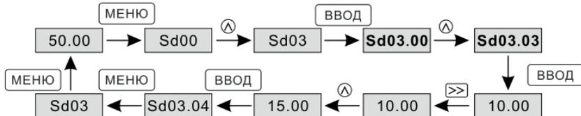
Рисунок 4-3. Пример изменения значения параметра
