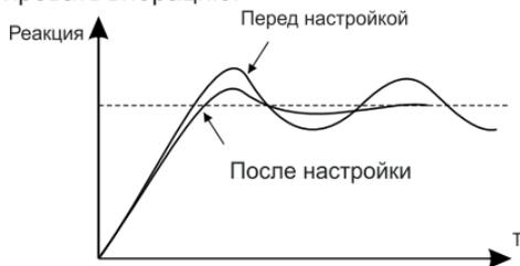
Контроль вибрации повышенной частоты: одинаковое время периода вибрации и установленного времени дифференцирования ( $T_d$ ) говорит о слишком сильном влиянии времени дифференцирования. Подавить такую вибрацию можно путем сокращения времени дифференцирования. Если при установке времени дифференцирования в 0.00 (отсутствует дифференциальное регулирование) вибрации не подавляются, уменьшите усиление.
