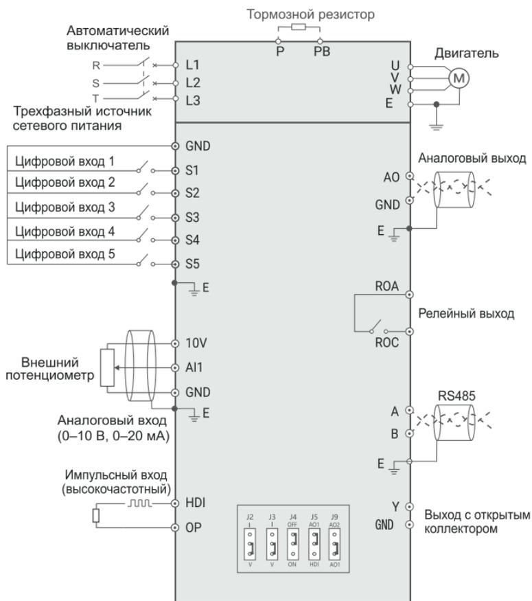
Рисунок 3-3. Схема основных электрических соединений (1)
